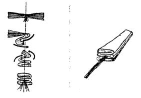
IT IS OF UTMOST IMPORTANCE THAT THE LINES SHOULD RUN STRAIGHT AND PARALLEL TO ONE ANOTHER ALL THE WAY FROM THE PARACHUTE SKIRT TO THE BRIDLE, WITHOUT ANY CROSSING OR TWISTING, AND THAT THE BRIDLE LIES SO THAT THEY JOIN ITS SIDE. THE BRIDLE SHOULD NOT BE TURNED OR TWISTED IN THE SUBSEQUENT STAGES OF FOLDING.
